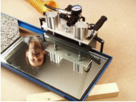
Um einen optimalen Kontakt des Klebebandes zur Fügefläche zu erhalten, muss das Band vor dem Entfernen der Schutzabdeckung mit einem geeigneten Werkzeug (Rakel, Andruckrolle) angepresst werden. Die Festigkeit einer Verklebung ist direkt abhängig vom Kontakt des Klebebandes zu den verklebten Oberflächen. Ein optimaler Andruck von 30 bis 50 N/cm<sup>2</sup> bringt Sicherheit für Ihre Verklebung. (1N = 102 g)
