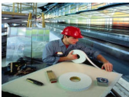
Das Klebeband unmittelbar nach der Reinigung bzw. dem Haftvermittlerauftrag (Abluftzeit beachten) auf die erste Fügefläche applizieren. Das Applizieren von Hand (Bild) ist eine heikle Arbeit. Deshalb gehören zum Klebe-System Maschinen, die das Aufbringen des Klebebandes optimieren und rationalisieren.
