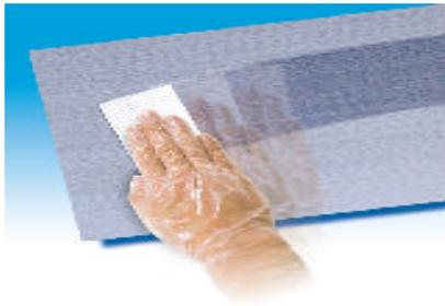
In einigen Fällen kann es notwendig sein, die Oberflächen vor dem Aufbringen des VHB™ Montageklebebandes mit einem Haftvermittler (Primer) zu beschichten. Einige Materialien (z.B. Kupfer, Messing, gewisse Kunststoffe) erfordern einen Primer, um eine bessere Benetzbarkeit zwischen Klebstoff und Werkstoffoberfläche zu erreichen. Bei Weich-PVC kann ein Primer eingesetzt werden, um Weichmacherwanderung zu verhindern.
